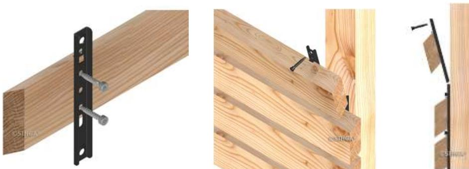
Komplektā iekļautas skrūves **L-BohrFix**. Skrūves galviņa, ar ko stiprina klipu pie atbalsta brusas, vienlaikus nodrošina atstarpi starp dēļiem bez papildus šablona pielietošanas. Tas ievērojami ietaupa montāžai paredzēto darba laiku. Mazākas vai brīvi izvēlētas atstarpes izveidei starp apšuvuma dēļiem, klipam paredzētas citas skrūvju ievietošanas atveres.
